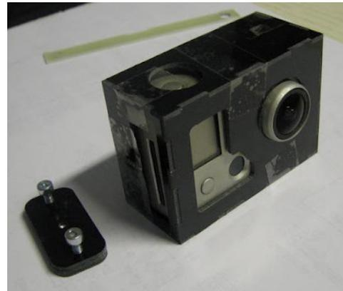
2. Teil 5 unter Zuhilfenahme der M3- Schraube und der M3 Mutter auf das Gehäuse positionieren und verkleben. Vorsicht: nicht die Schraube in die Mutter einkleben.
