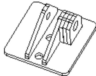
1. Die Teile 7 und 8 an den Klebeflächen mit Sekundenkleber versehen und zusammenstecken und mit Sekundenkleber verkleben.
